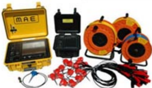
Indagini e prove sismiche a rifrazione, M.A.S.W e Down-Hole
